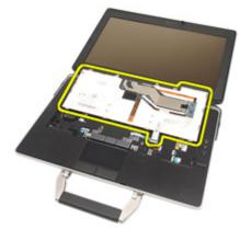
9. キーボードケーブルをキーボードに固定するテープを外します。
