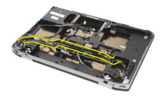
26. モデム-マザーボードコネクターの端を引き抜きます。
