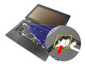
**10.** モデムカードからモデムケーブルの接続を切り、システムから取り 外します。
