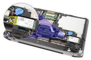
8. WWAN カードをコンピューターに固定しているネジを外します。
