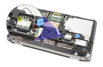
9. WLAN カードをスライドさせてシステム基板のスロットから取り外します。
