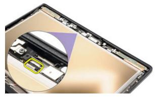
6. カメラをディスプレイアセンブリに固定する拘束ネジを外します。
