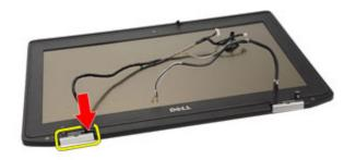
25. 左側のヒンジからディスプレイヒンジカバーを取り外します。
