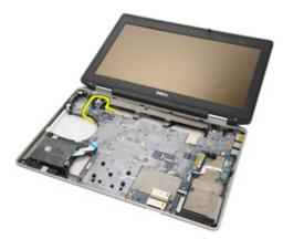
**29.** スライドさせながら、ポートコネクターからシステム基板のロックを解除します。
