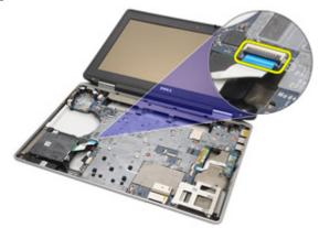
**12.** スマートカードリーダーをコンピューターに固定しているネジを外します。
