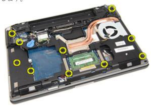
**14.** システムを裏返し、パームレストアセンブリをコンピューターに固定しているネジを外します。
