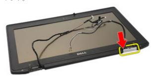
27. 右側のヒンジからディスプレイヒンジカバーを取り外します。
