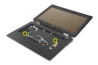
**15.** LED、スマートカード、タッチパッド、RFID、ExpressCard ケーブルの接続を切り、システム基板から取り外します。
