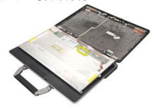
7. ディスプレイパネルから LVDS (低電圧差動信号) ケーブルを取り外します。
