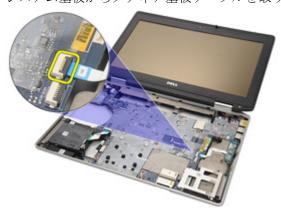
15. メディア基板をコンピューターに固定しているネジを外します。
