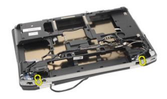
**24.** アンテナコネクター、ビデオコネクター、カメラコネクターを引き 抜きます。
