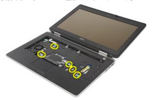
**16.** プラスチックスクライブを使って、てこの作用でパームレストの右上を取り出し、パームレストの右側にスクライブを滑らせてスナップを解除します。
