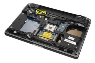
**24.** ビデオカメラケーブルと LED ケーブルの接続を切り、システム基板から外します。
