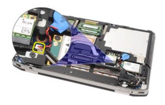
9. コイン型電池をてこの作用でコンピューターから取り出します。
