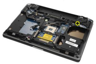
26. システム基板を裏返し、ネジを外します。
