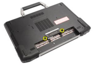
**5.** キーボードをシステムに固定しているネジを外します。
