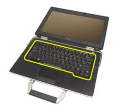
7. システム基板からキーボードケーブルを取り外します。
