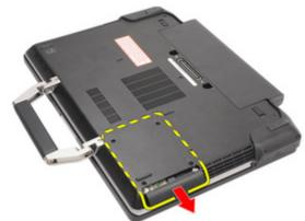
**5.** ハードドライブキャディをハードドライブに固定しているネジを外します。
