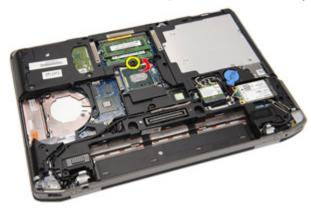
11. システムからプロセッサーを取り外します。
